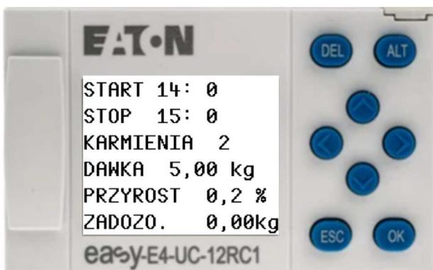
Fertig! Der Feeder hat die von uns eingestellten Einstellungen geladen und befindet sich im Betriebsmodus, was durch die grüne LED am Gehäuse bestätigt werden sollte.
